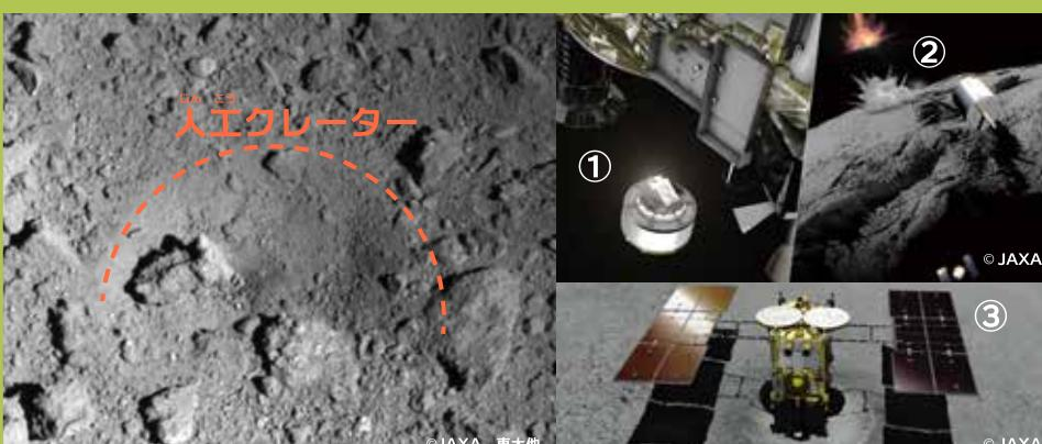
はやぶさ2は数多くの世界初を達成しています。その中でも重要なことは小惑星のより内側の岩石を取ったことです。それは①衝突装置を爆発させ、②表面に穴をあけ人工クレーターを作り(点線の下側)、③はやぶさ2を着陸させ、このクレーター周辺から岩石を取ったことでした。
